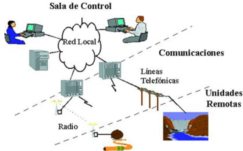
Figura 44 Ejemplo de un sistema de control 81
