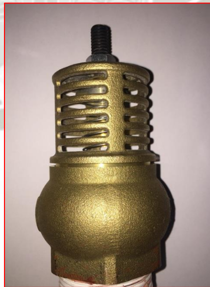
Figura N° 42: Válvula de impulso normalmente abierta
