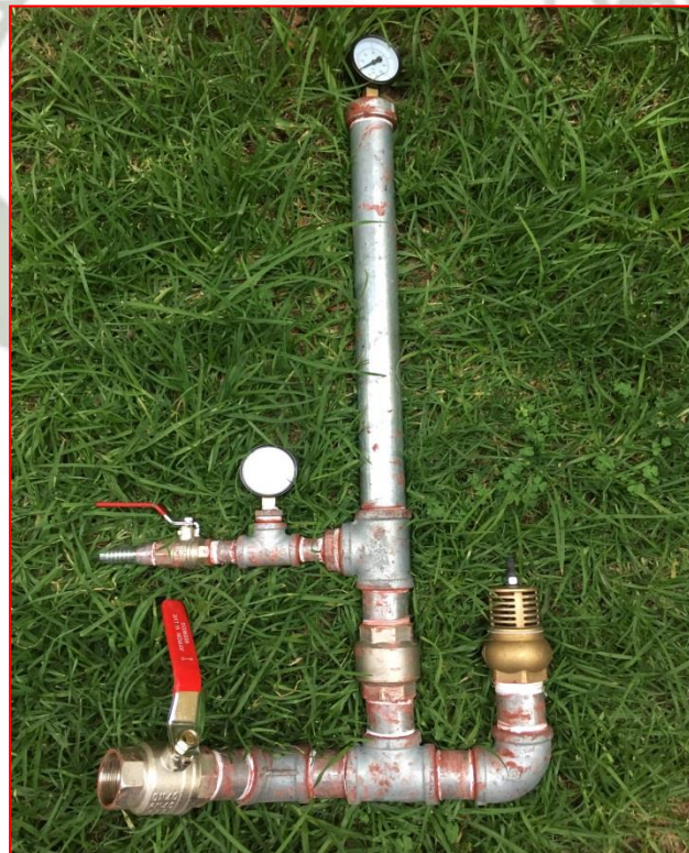
Figura N° 46: Ensamble bomba de ariete Fuente: Propia
