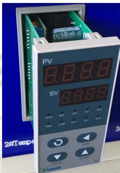
Figura 19: Retirando el panel frontal del controlador Fuente: Elaboración Propia
