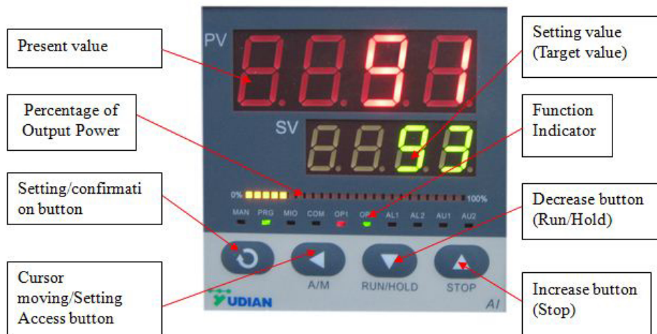
Figura 16: Panel Frontal de un controlado Yudian AI
