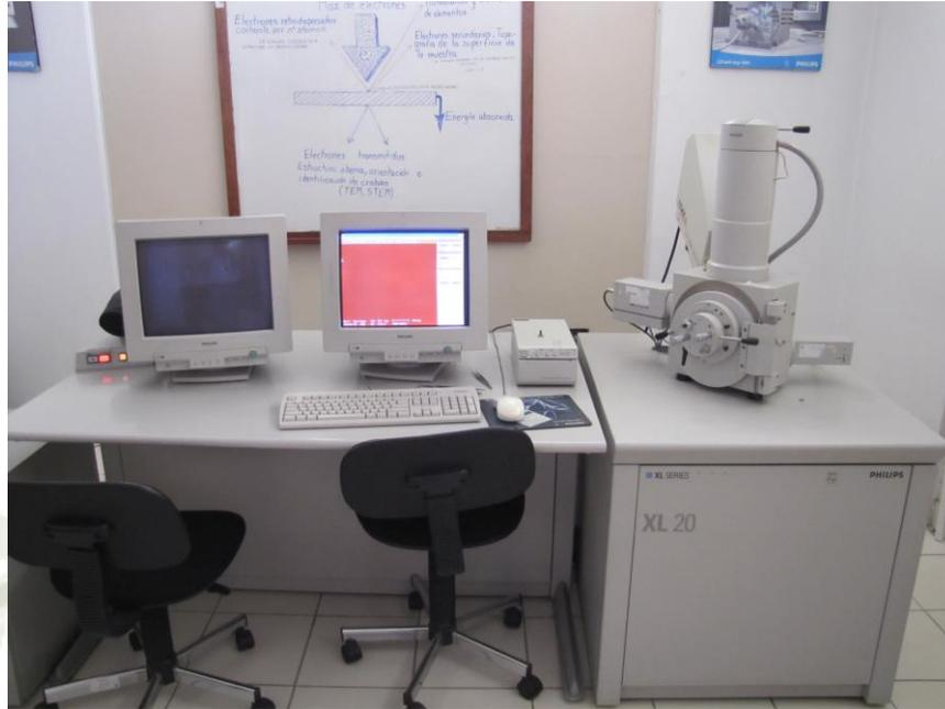
1.- Microscopio electrónico de barrido SE XL20 PHILIPS
