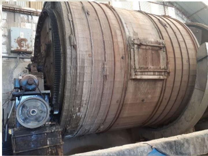
Figura 4: Botal en el que se realiza el remojo
