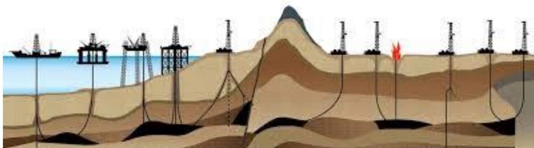
Fig. 3.2 Tipos de pozos de perforación
