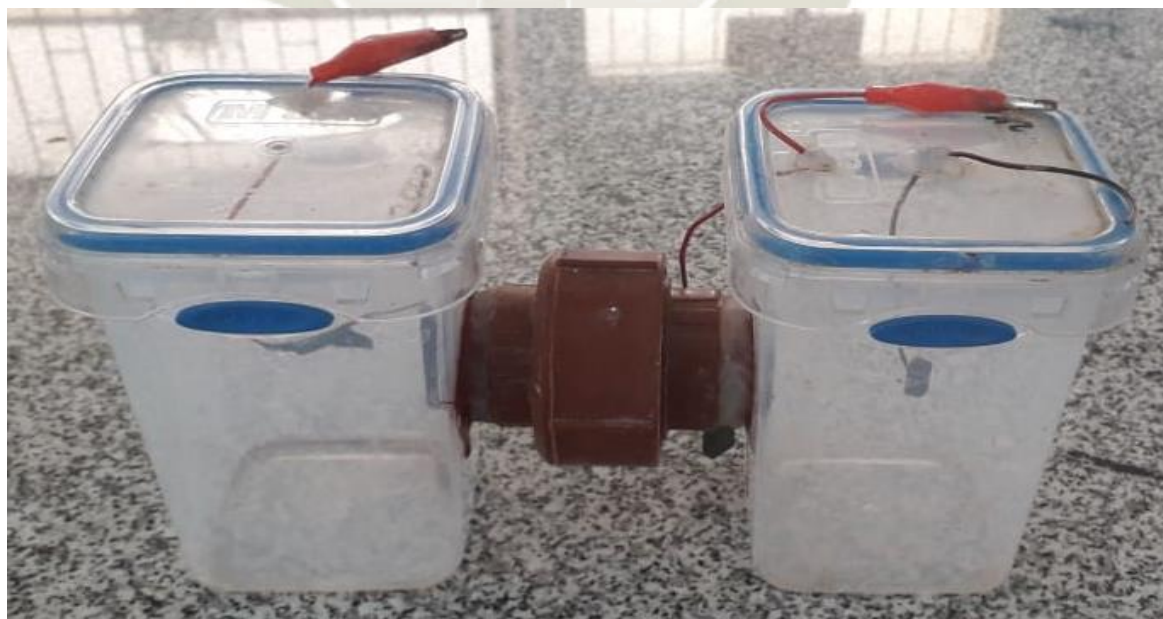
Figura 27. Diseño del prototipo final y totalmente ensamblado para su uso como CCM.
