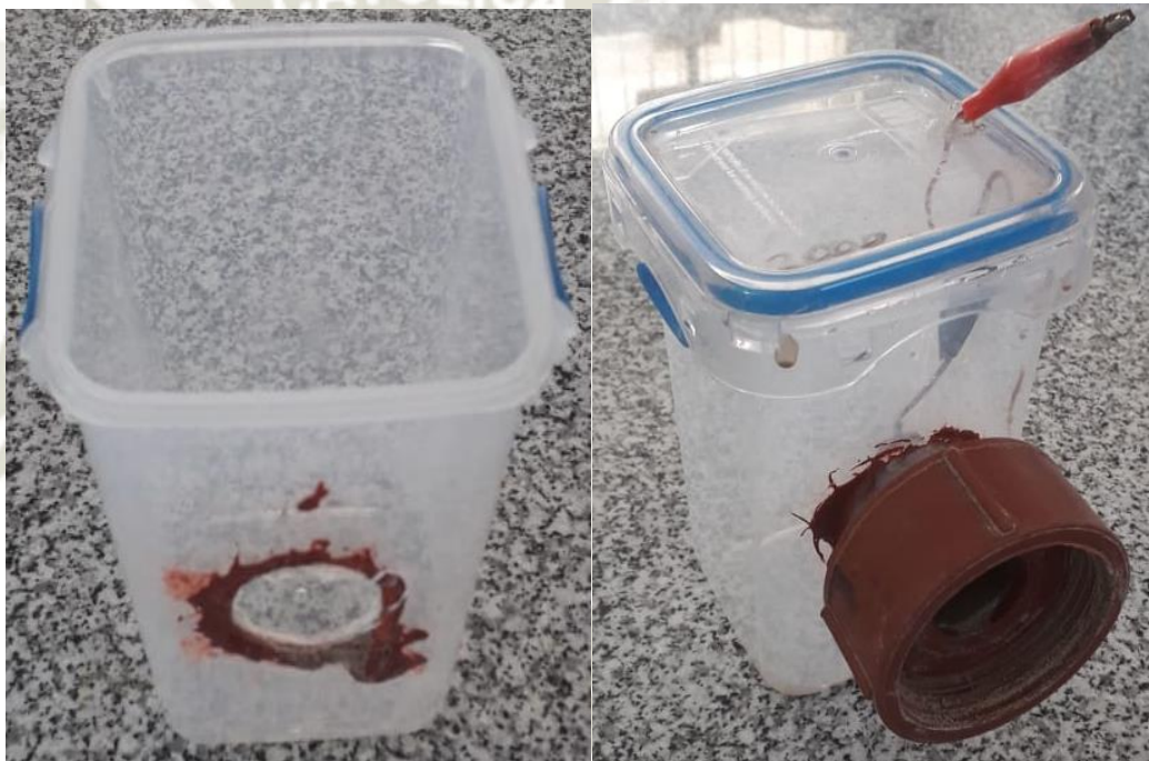
Figura 12. Celdas listas para el ensamble total de la CCM, donde se puede visualizar el puente donde se encuentra la membrana de Nafion.
