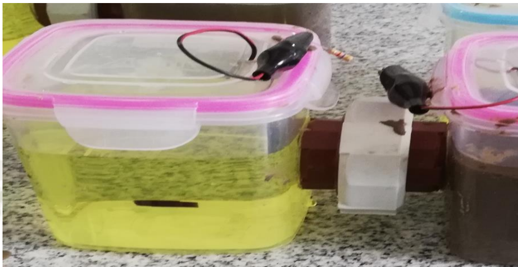
Figura 13. Ferricianuro de Potasio disuelto en agua, dentro de una celda de combustible microbiana.
