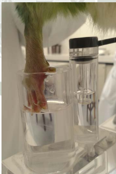
Figura N°24: Medición de pata inflamada en ml mediante pletismómetro digital
