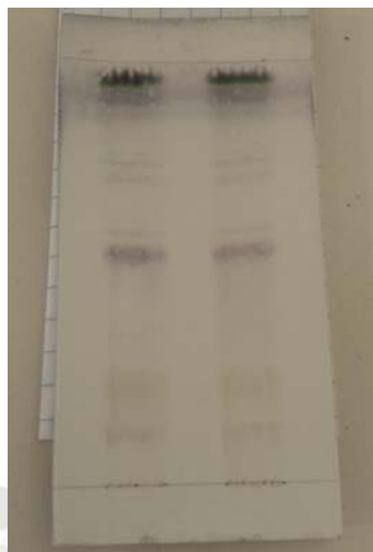
Figuras N°10 y 1: Análisis cromatográfico general del extracto fluido (1:5) de Cajophora rosulata (ortiga colorada)
