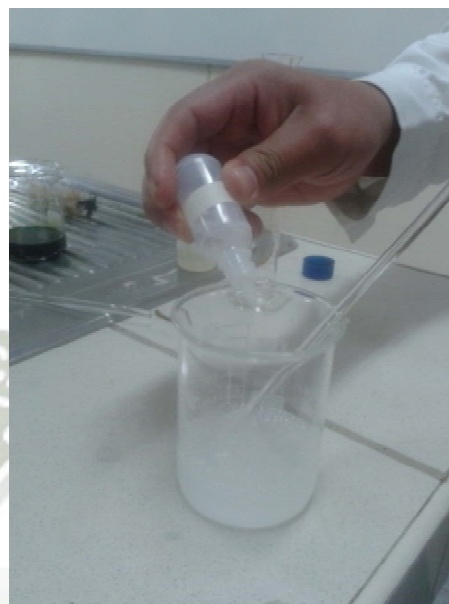
Figura N°21: Alcalinización con trietanolamina
