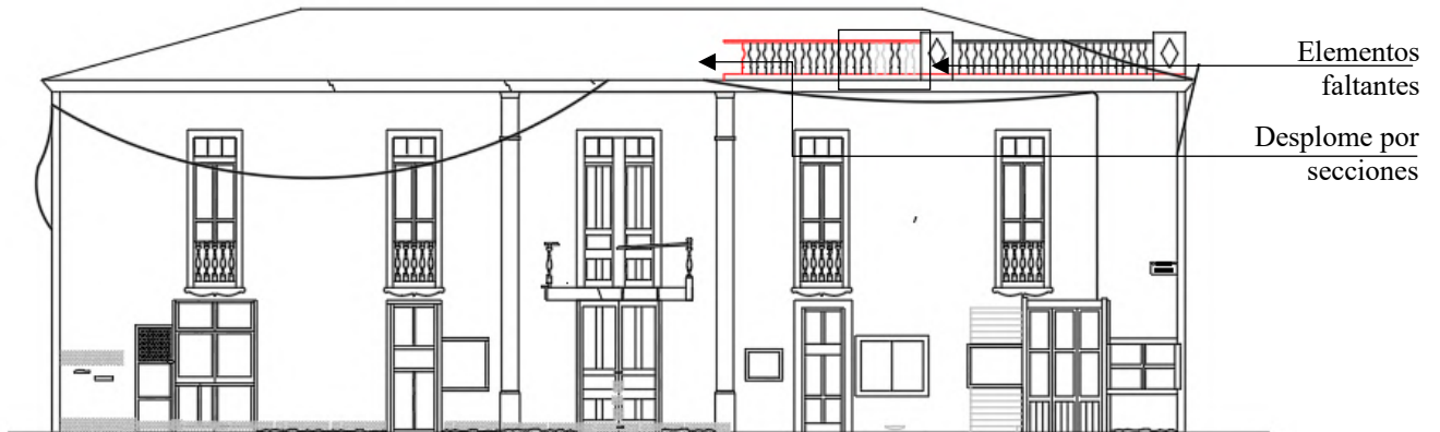
Imagen 87: Esquema de lesiones en ornamentaciones – balaustres (E: 1/200).
