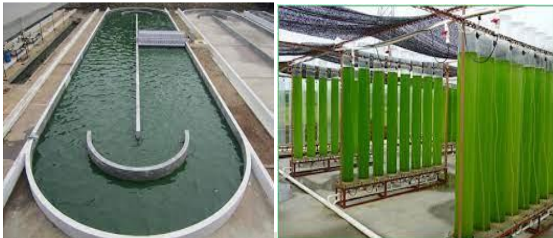
Figura 1.5. Sistemas de cultivos de cianobacterias. A) Estanques de canalización. B) Fotobiorreactores tubulares (67).
