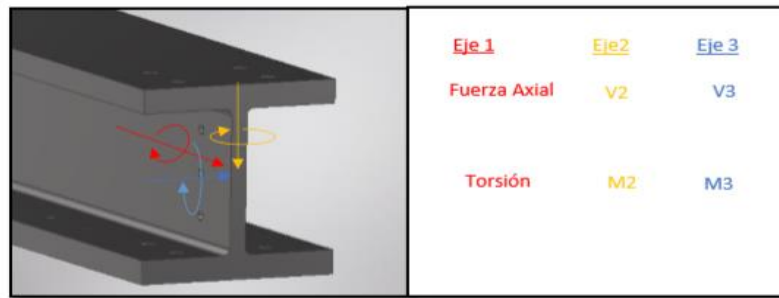
Fig. 133 Distribución de fuerzas en perfiles
