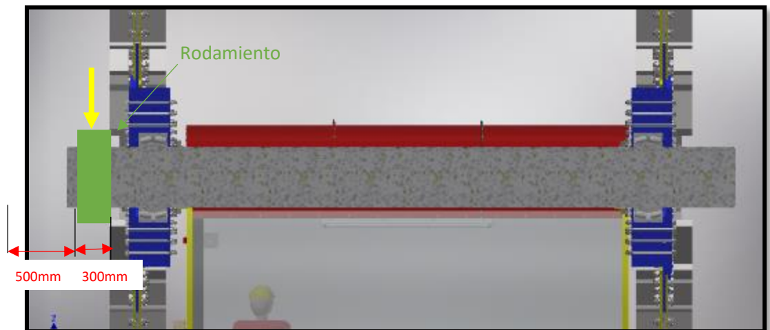
Fig. 147 Distribución de fuerzas del eje central
