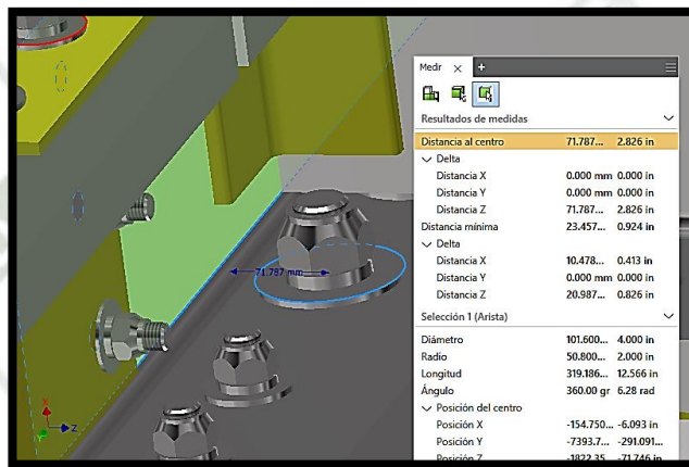
Fig. 122 Distancia entre alma perfil W y perno del ala de la unión 5 con PL 3/8".
