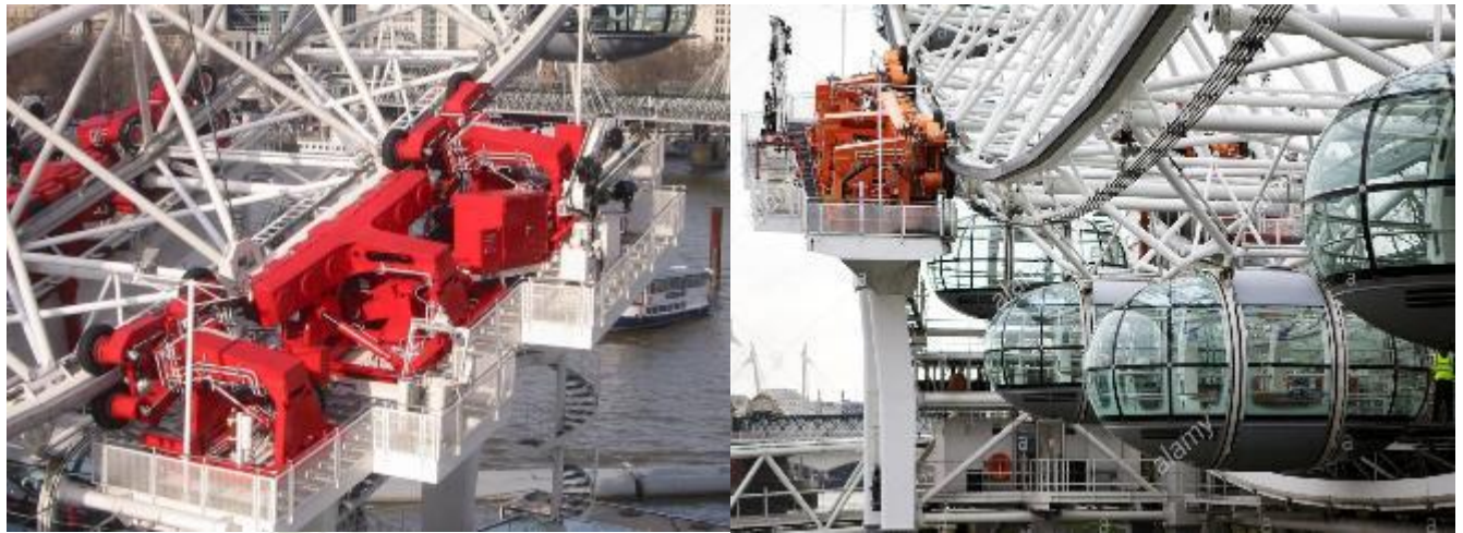
Fig. 7 - Fig. 8 Sistema de transmisión hidráulica del London Eye
