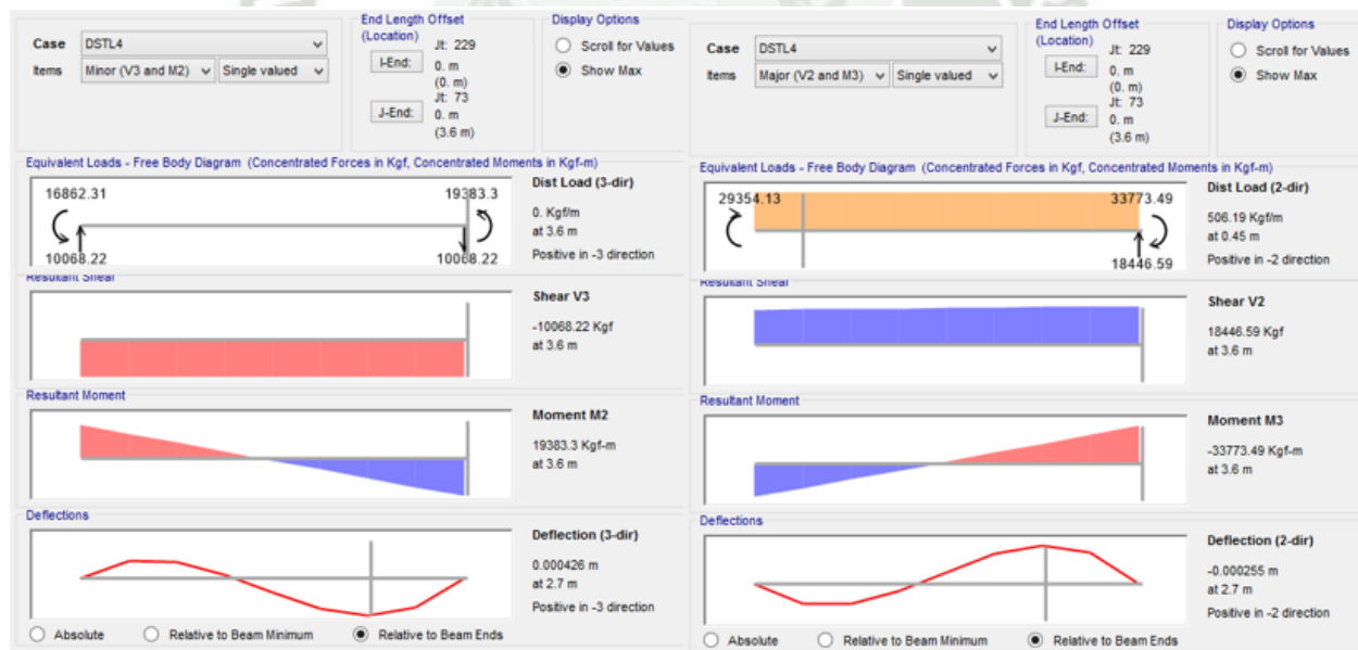
Fig. 82 - Fig. 83 Diagrama de momentos y cortantes en el perfil “Conector de anillos”
