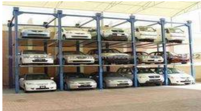
Figura 5: Sistema de parqueo tipo rompecabezas o Puzzle.
