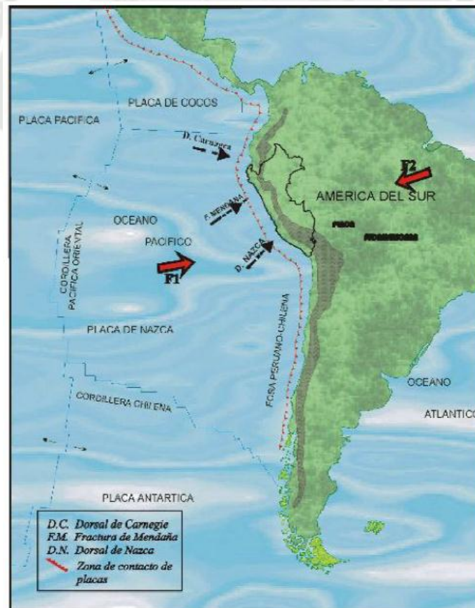
Figura 3.1 Proceso de convergencia de la placa de Nazca y la placa Sudamericana según (De Mets et al, 1999) mostrado en (Bernal y Tavera, 2002)
