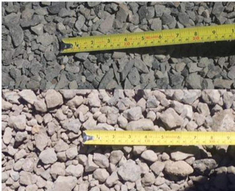
Figura 4.12 (a) Agregado grueso de un tamaño aproximado de \frac{1}{2} pulgada (b) Agregado grueso de un tamaño aproximado de 1 pulgada
