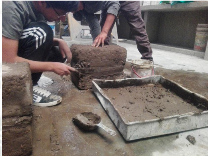
Figura 4.35. Elaboración de pilas de adobe.
