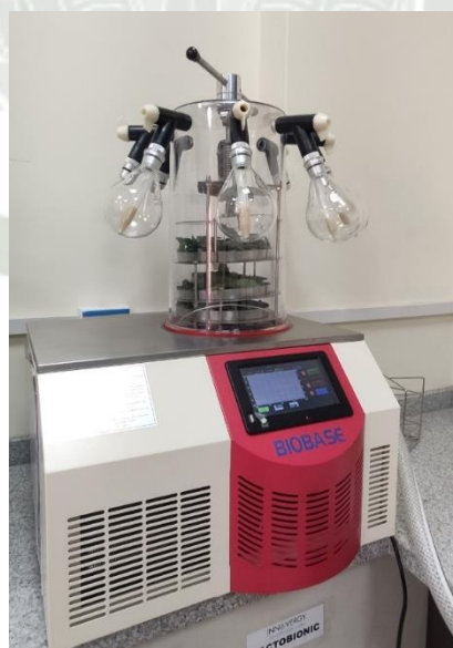
FIGURA 4.2 TUBOS CON EL EXTRACTO PURO DE LATEX COLOCADOS EN EL LIOFILIZADOR
