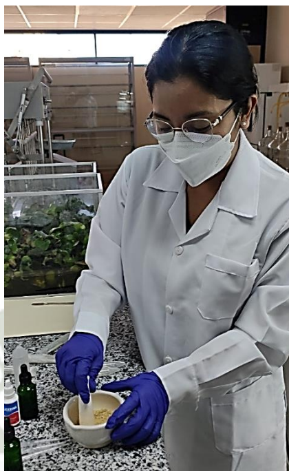
FIGURA 4.5 PULVERIZANDO LA FICINA LIOFILIZADA FUENTE: PROPIA
