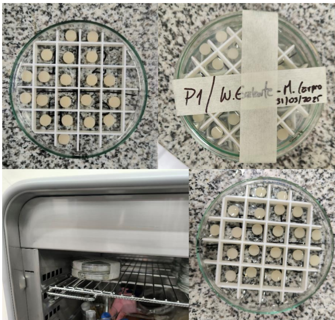
Figura 8 Condiciones simuladas con ácido clorhídrico
