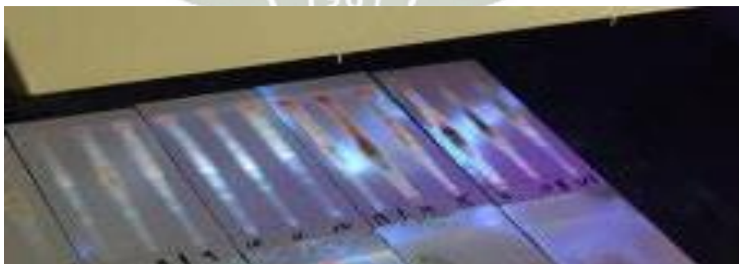
Figura 3. 5: Placas de TLC bajo radiación UV.
