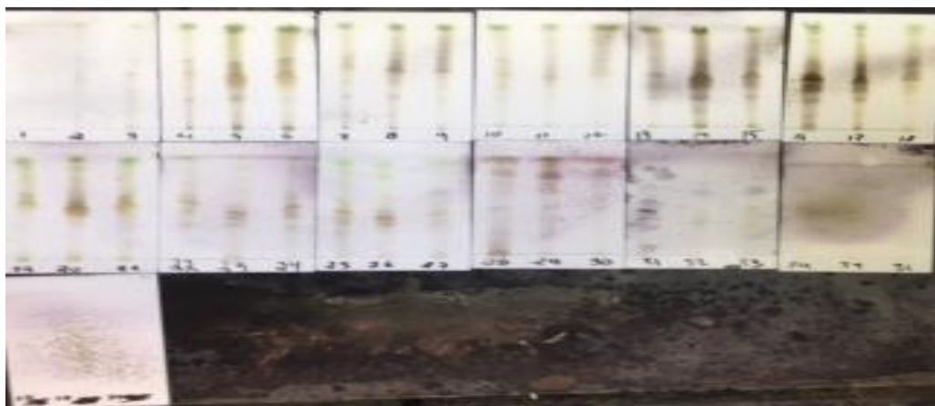
Figura 3.3: Placas de TLC resultantes del extracto separado luego de la columna de fraccionamiento
