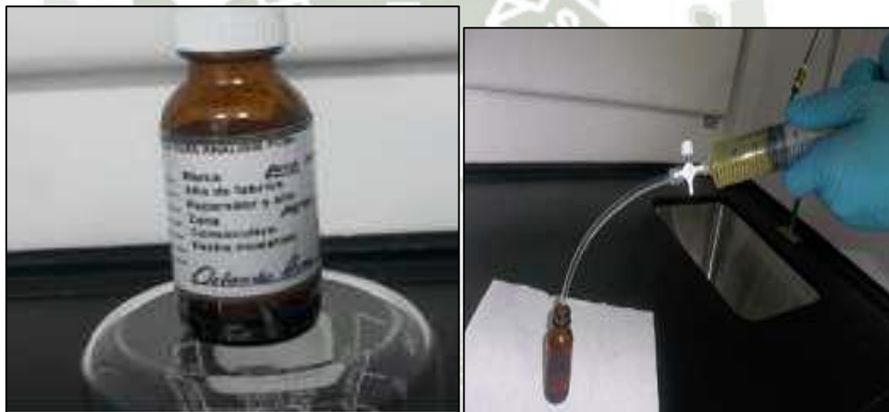
Figura 2: Muestra de aceite de equipos para análisis y descarte de PCB
