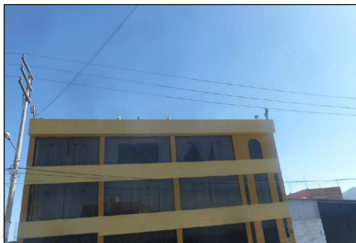
Foto N°19: Deficiencia 5018. Conductor Incumple Distancia de Seguridad Respecto a Estructura y/o Cable de Comunicación.
