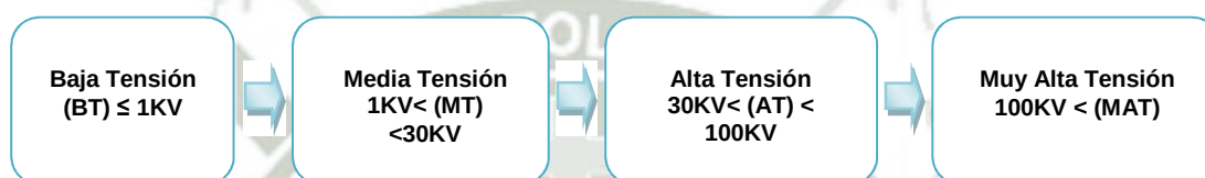
Figura 2: Niveles de Tensión en el Sector Eléctrico
