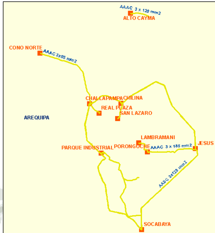
Figura 14: Sistema de Distribución 33/10 Kv – Arequipa
