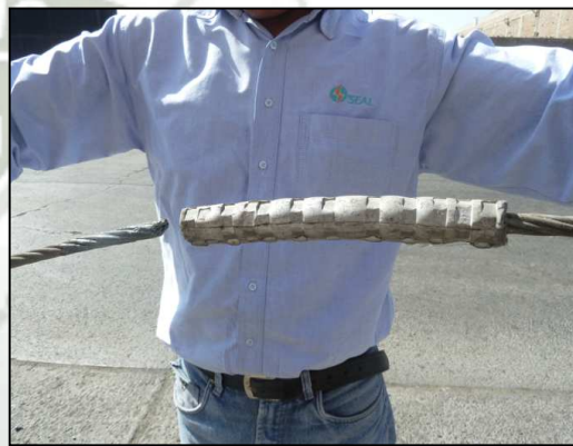
Figura 45: Empalmes mal utilizados según su aplicación
