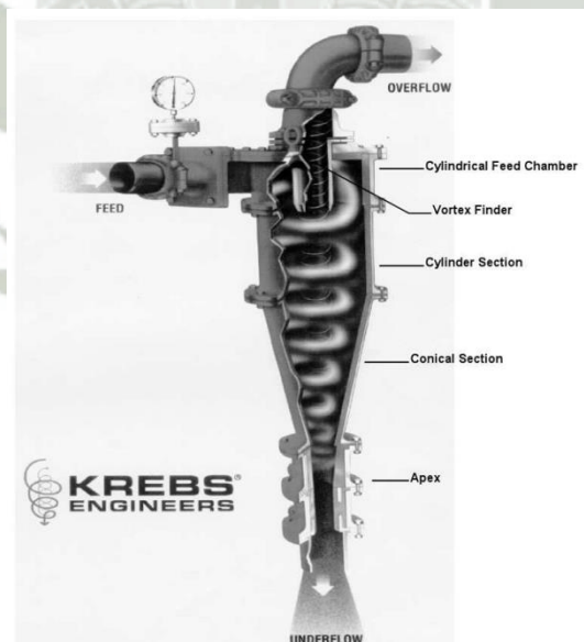
Figura 2.6: Esquema de funcionamiento de un hidrociclón Fuente: (Universidad de Chile, 2010)
