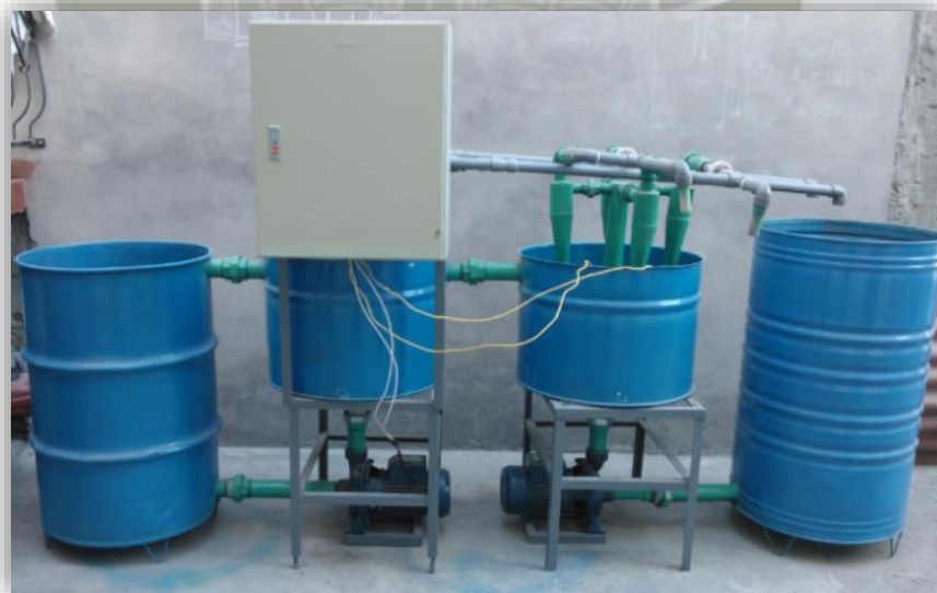
Figura 3.18: Sistema de recuperación de agua de relaves (parte mecánica).
