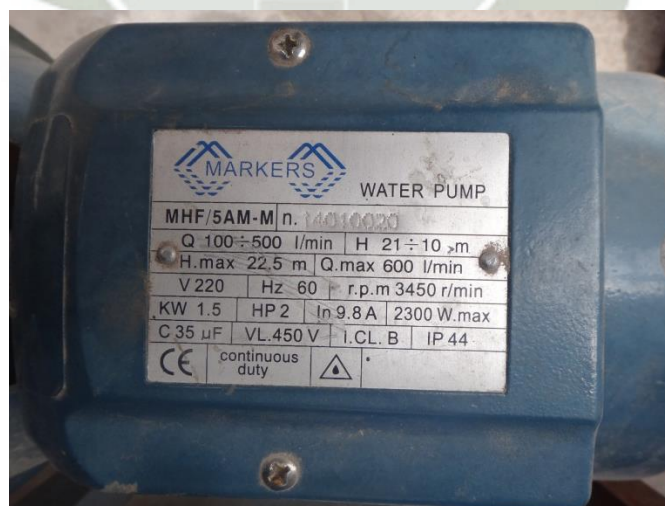
Figura 3.11: Placa de datos de bomba centrífuga.
