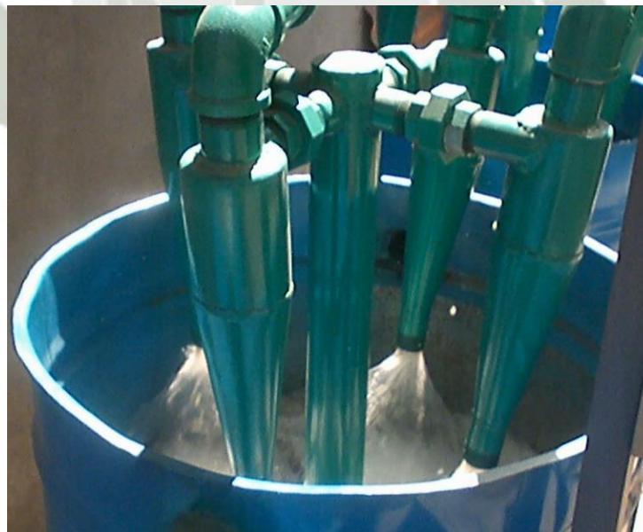
Figura 3.62: Funcionamiento correcto de los hidrociclones.
