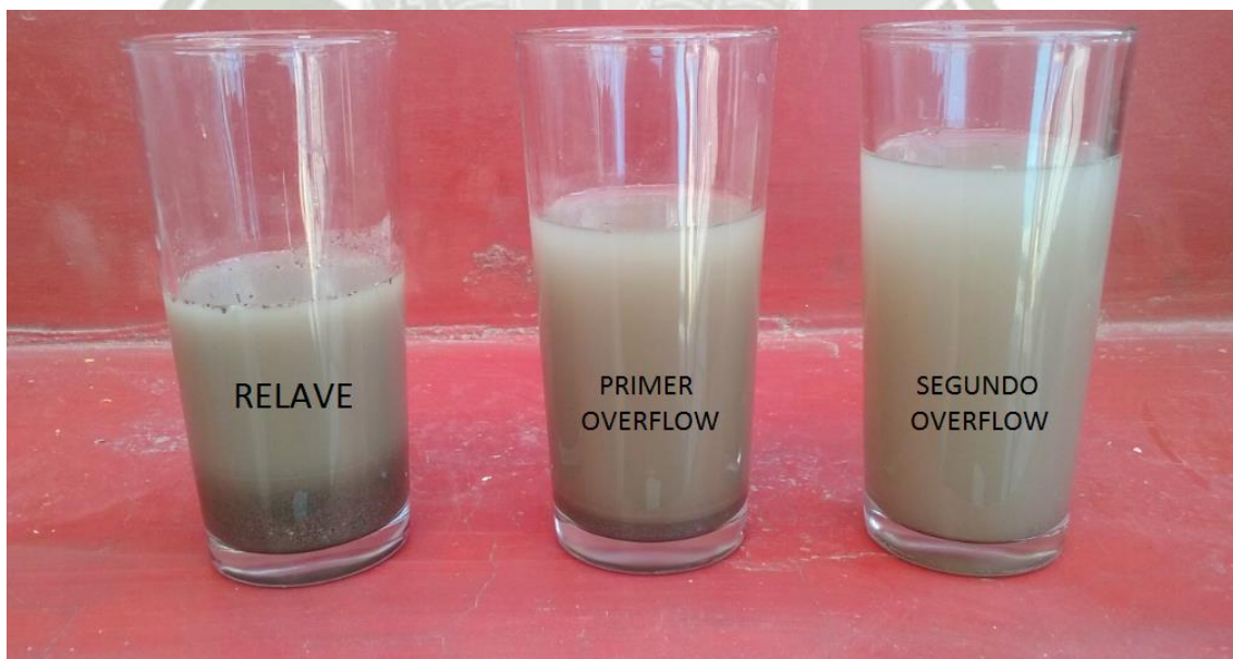
Figura 3.68: Niveles de concentración en las distintas etapas. (2° nido de hidrociclones OVERFLOW)
