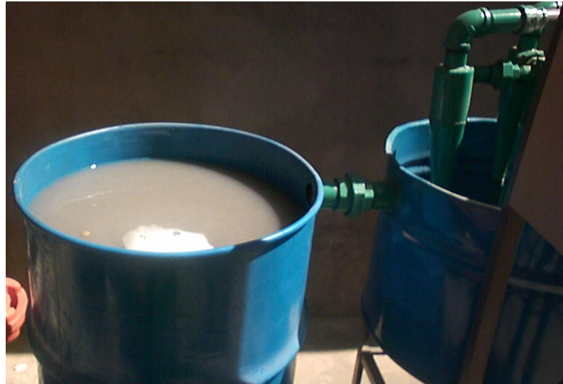
Figura 3.61: Tanque lleno de relave para la prueba de hidrociclones.
