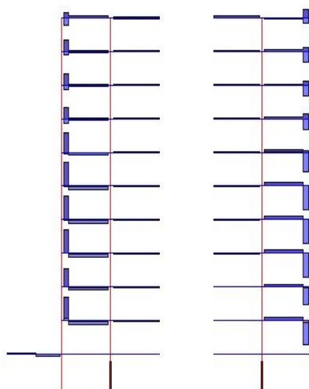
Figura N° VIII.46.: Envoltentes de Momentos Torsores – Eje K
