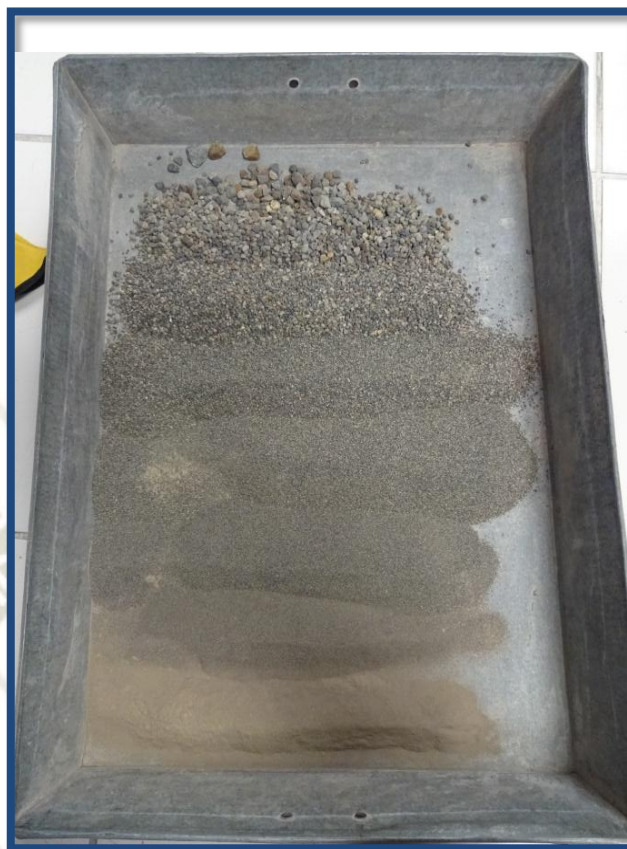
Figura N° 44: Análisis granulométrico del agregado fino
