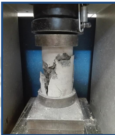
Figura N° 68: Fractura diagonal- Tipo V, según la NTP 339.034
