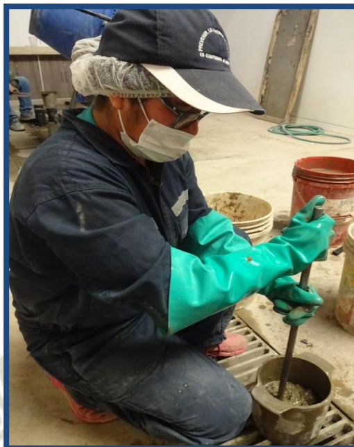
Figura N° 55: Ensayo de peso unitario del concreto fresco
