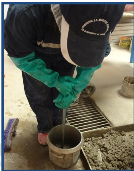
Figura N° 59: Compactado con la varilla en la olla de Washington
