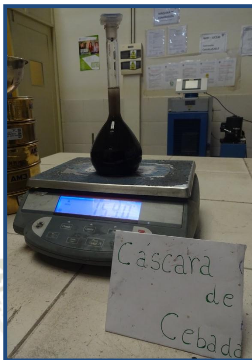
Figura N° 27: Peso de la fiola con la muestra después de eliminar el aire por 20 minutos
