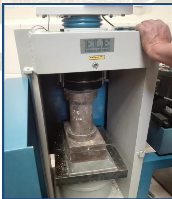
Figura N° 67: Colocado de la probeta en la compresora
