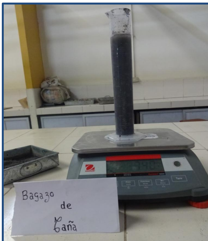
Figura N° 33: Peso de la probeta con la muestra después de eliminar el aire por 20 minutos
