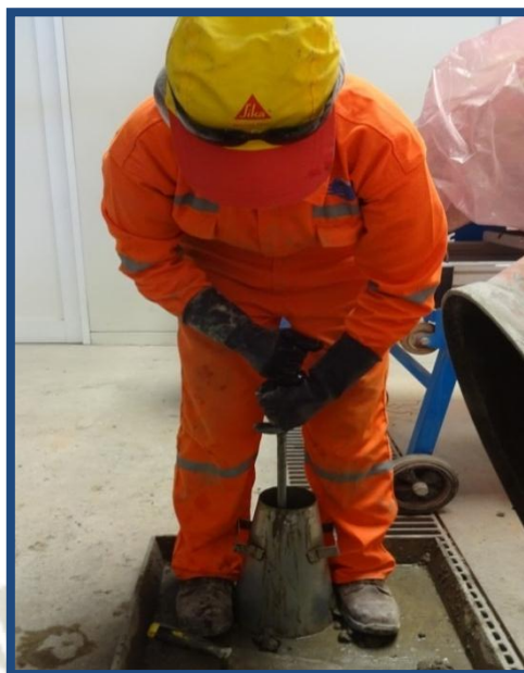
Figura N° 53: Compactado de cada capa con la varilla de acero
