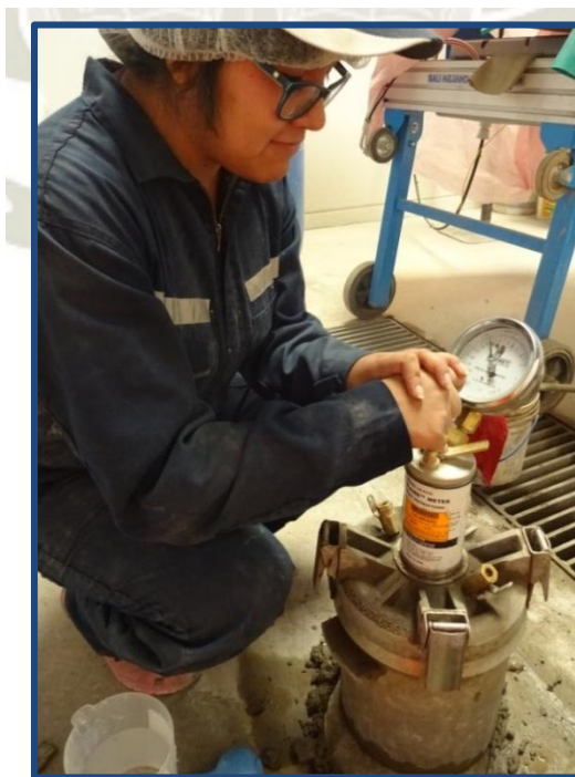
Figura N° 62: Bombeando aire hasta que marque cero el dial
