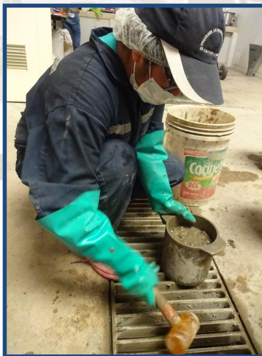
Figura N° 56 : Golpear 4 veces en cada lado del molde con el martillo de goma
