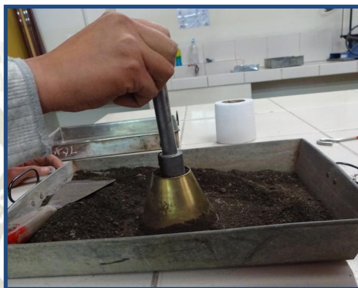
Figura N° 47: Comprobación si la muestra de agregado fino se encuentra en condiciones (SSS) según la NTP 400.022
