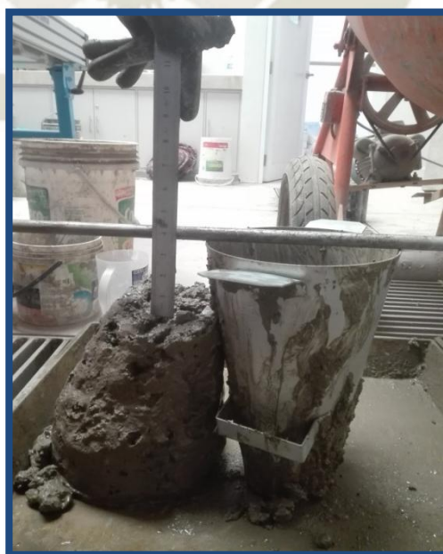
Figura N° 54: Medición del asentamiento del concreto con CHM
