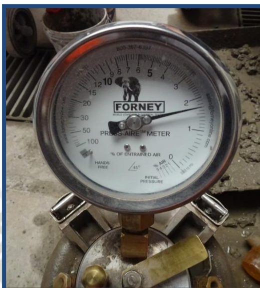
Figura N° 63: Contenido de Aire del concreto con CHM
