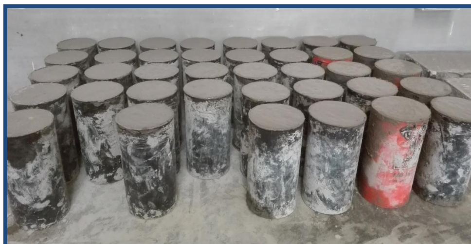
Figura N° 65: Elaborado de las probetas cilíndricas de acuerdo a la NTP 339.183
