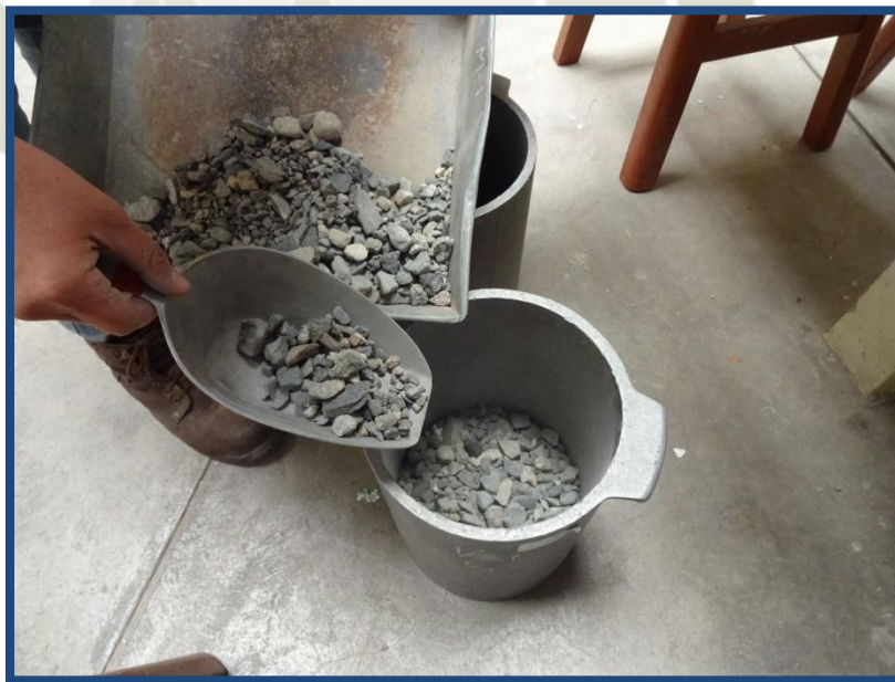
Figura N° 40: Peso unitario seco suelto del agregado grueso
