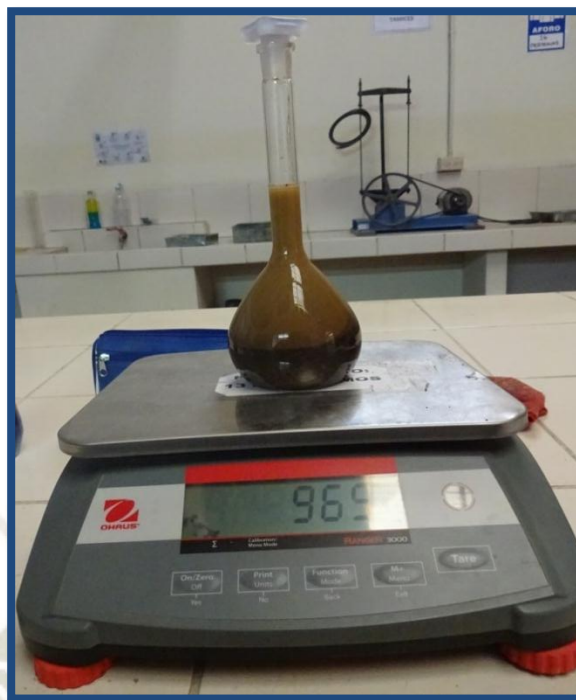
Figura N° 48: Peso del matraz aforado con la muestra después de eliminar el aire por 20 minutos
