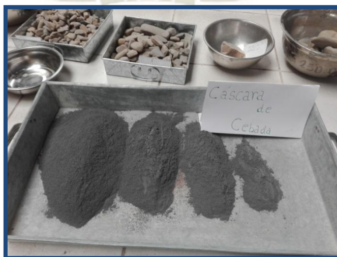
Figura N° 23: Análisis Granulométrico de la CCC
