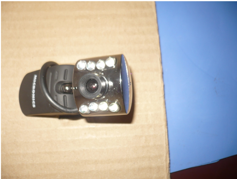
fotografía 05: Detalle de la cámara web con iluminación LED
