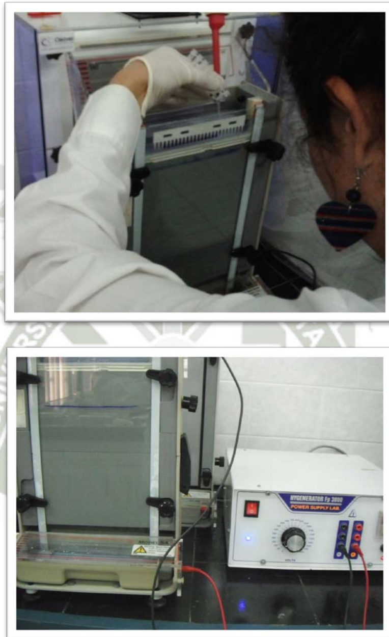
Figura N° 29. Cámara de electroferesis vertical utilizada para correr las muestras amplificadas con AFLP.
