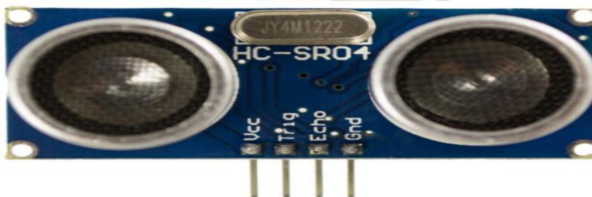
Figura 15. Sensor ultrasonico. Adaptado de "Sensor De Ultrasonido HC-SR04 rango de sensado de 3-300cm" por electropro, 2019.
