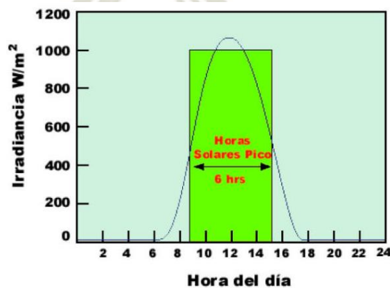
Figura 2-5: Irradiancia y horas solares pico (insolación) durante un día soleado.
