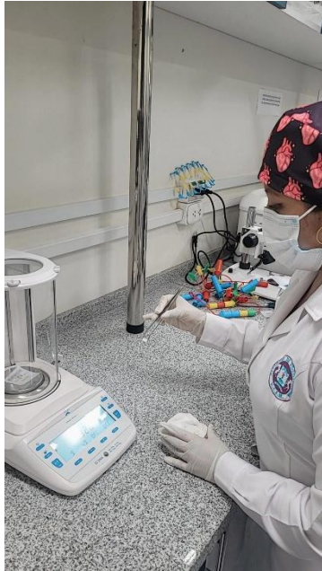
Figura 5. Pesaremos cada uno de los 36 discos de ionómero de vidrio de las diferentes marcas: Ketac Molar, Vitrebond 3M y Voco en la balanza analítica.
