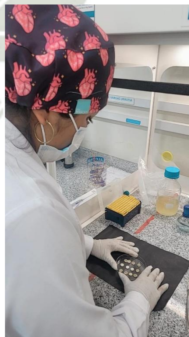
Figura 8. Posteriormente se puso 80 uL de inóculo de Candida albicans en los discos de ionómero de vidrio de las diferentes marcas: Ketac Molar, Vitrebond 3M y Voco
