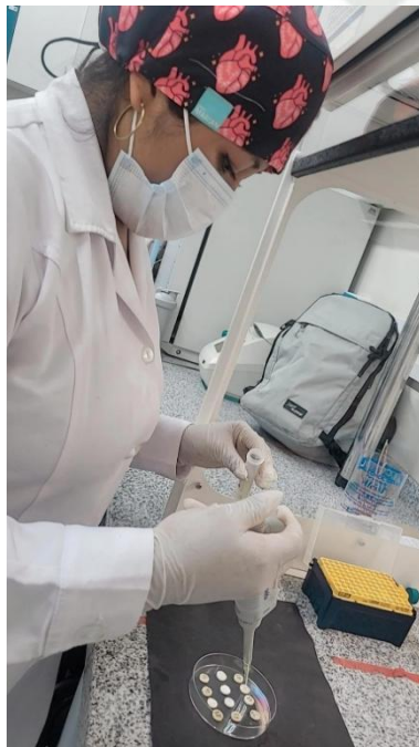
Figura 8. Posteriormente se puso 80 uL de inóculo de Candida albicans en los discos de ionómero de vidrio de las diferentes marcas: Ketac Molar, Vitrebond 3M y Voco
