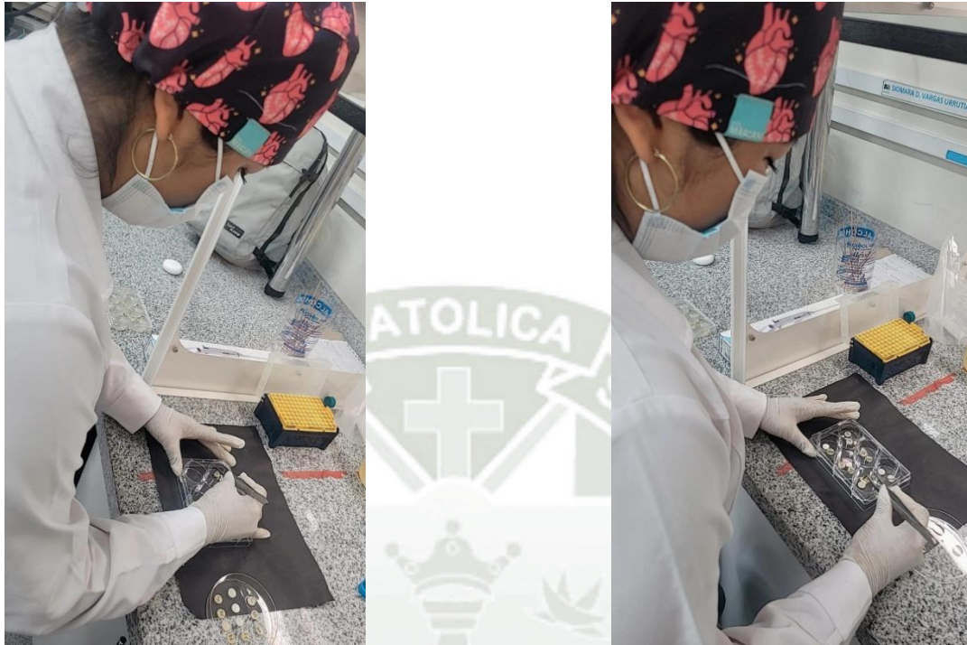
Figura 9. Vamos a distribuir los discos en una placa de cultura celular de seis pozos, luego se dejó reposando a temperatura ambiente por dos horas (eta es la etapa de preadhesión)
