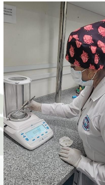
Figura 5. Pesaremos cada uno de los 36 discos de ionómero de vidrio de las diferentes marcas: Ketac Molar, Vitrebond 3M y Voco en la balanza analítica.
