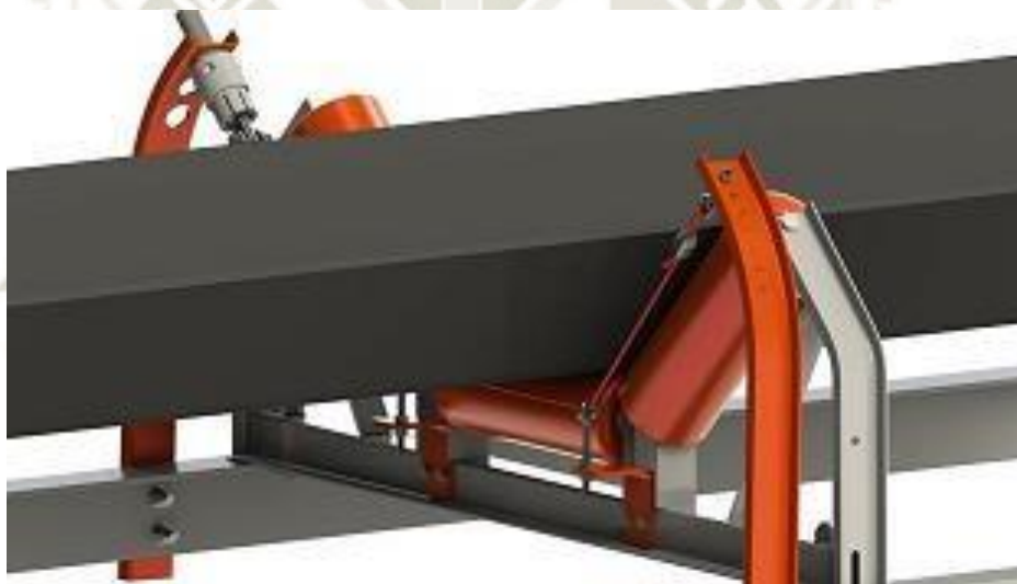
Figura 16: Instalación del sensor de rotura de faja.
