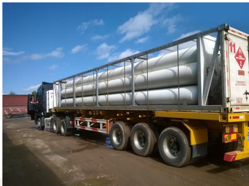
Figura 3. Transporte de GNC de 8000 m 3 Fuente: SGS (2015)
