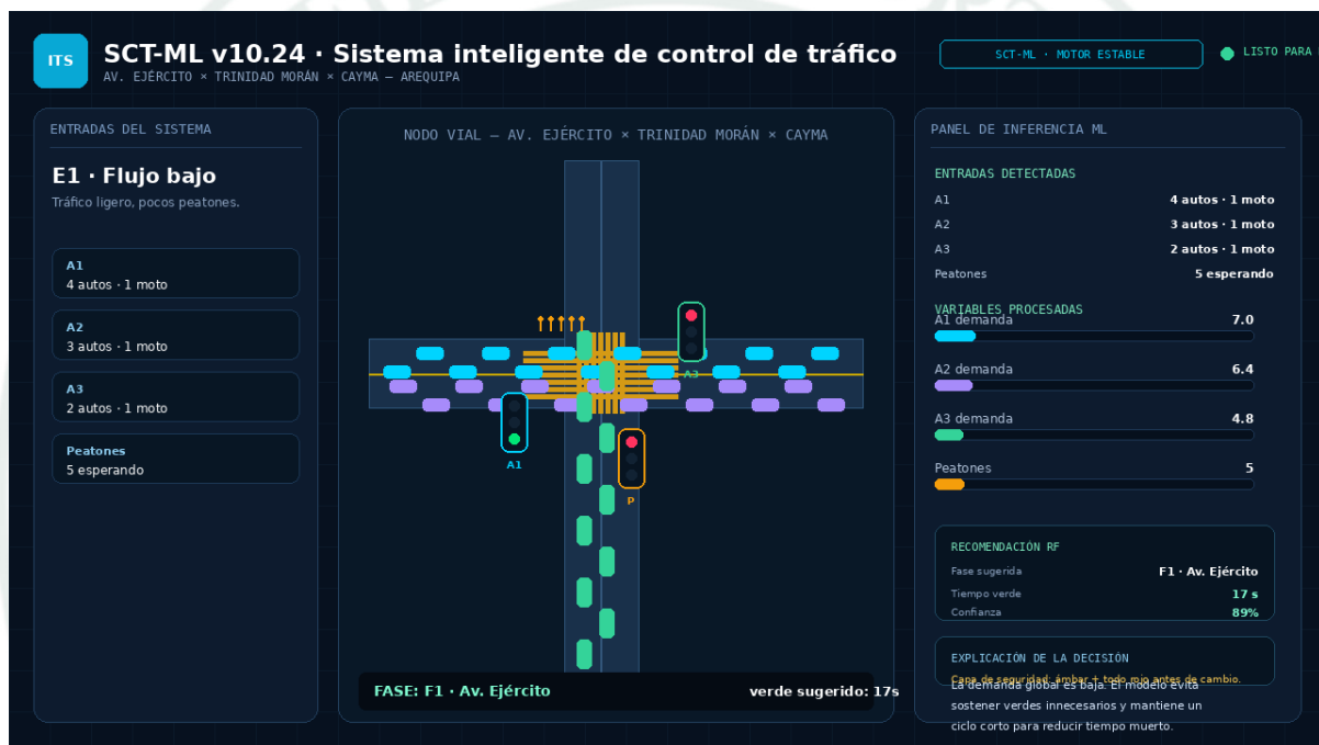
Figura A6.1. Vista de escenario simulado con entradas detectadas y decisión priorizada
