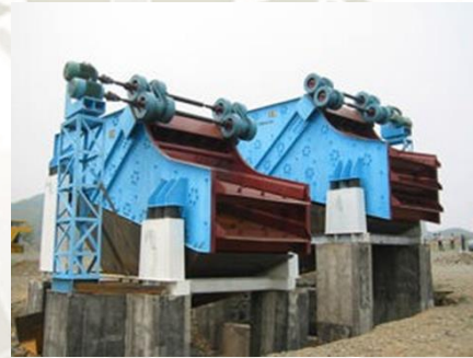
Figura 20: Clasificadoras vibratorias montadas en serie para la clasificación de arena.
