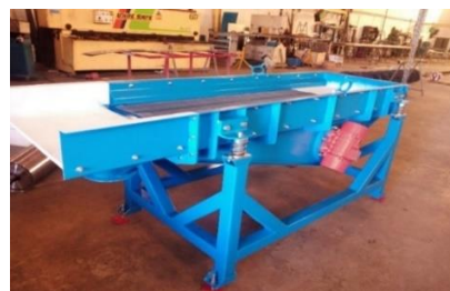
Figura 3: Estructura de un transporte vibratorio
