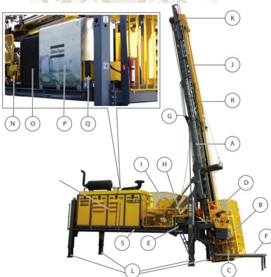
Figura 20: Partes de la perforadora Atlas Copco CT20
