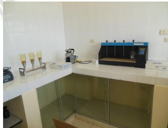
LABORATORIO DE CONTROL DE PROCESOS DE LA PLANTA DE TRATAMIENTO – EQUIPO DE PRUEBA DE JARRAS
