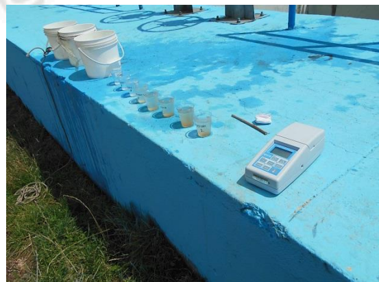
LAVADO DE UNA DE LAS UNIDADES DE FILTRACIÓN, Y HERRAMIENTAS PARA MEDIR EL TIEMPO DE LAVADO ÓPTIMO
