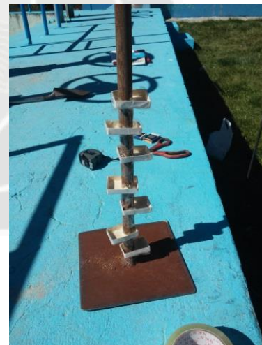
PROCEDIMIENTO Y HERRAMIENTAS PARA MEDIR LA EXPANSIÓN DEL MEDIO FILTRANTE
