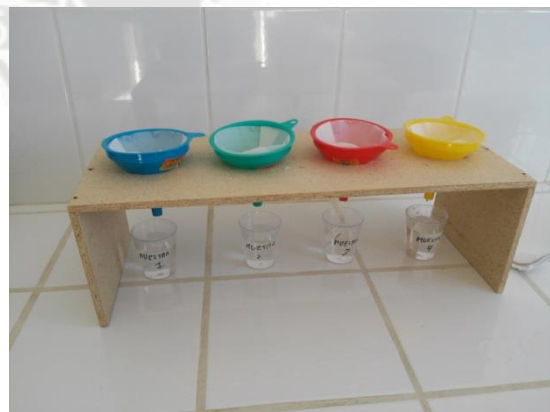
Equipo de prueba de jarras y accesorios para filtración directa
