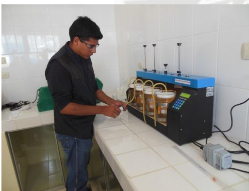
Equipo de prueba de jarras y accesorios para filtración directa
