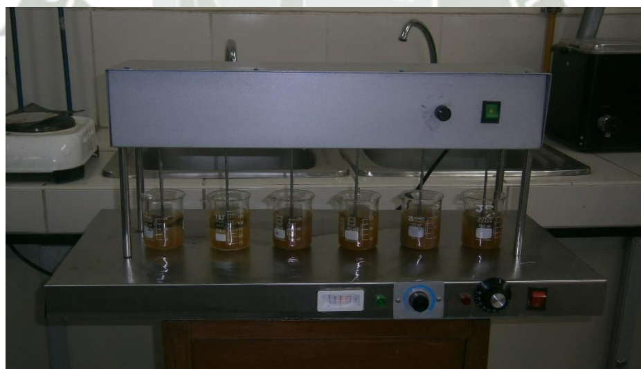
FIGURA N° 31. Proceso de adsorción con el Jar Test.
