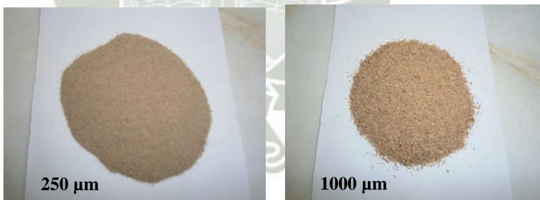
FIGURA N° 19. Material tamizado de tamaño 250 µm (izquierda) y tamaño 1000 µm (derecha).
