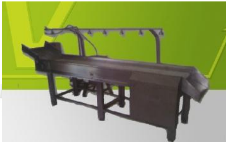
Figura 39. Faja transportadora con aspersores de agua
