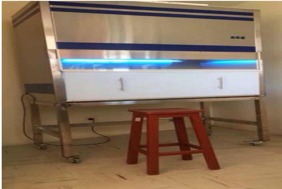
FOTOGRAFIA 02. Cámara de flujo laminar instalada en el Laboratorio.
