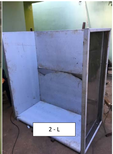
2-J;2-K;2-L. Armado y Plegado de las Planchas de Acero Inoxidable
