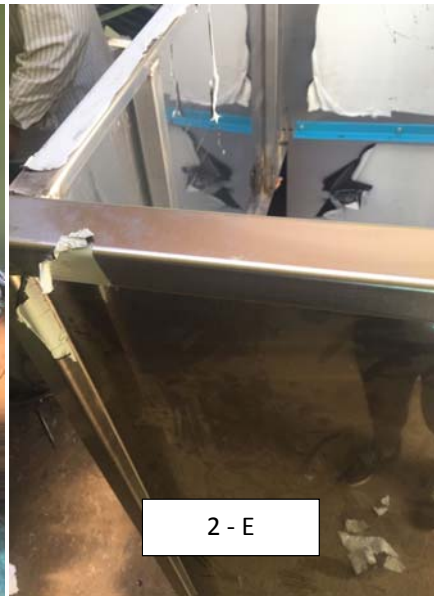
2D, 2E, 2F Armado y Plegado de las Planchas de Acero Inoxidable
