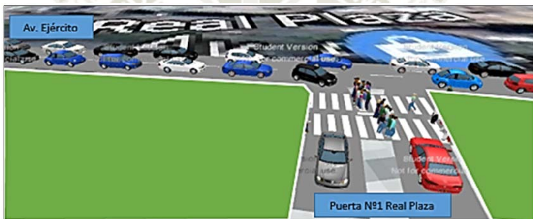
Figura 48. Simulación de estado actual en intersección ingreso y salida Real Plaza (Puerta N°1) - Av. Ejército Fuente: Elaboración propia con base en PTV Vissim 9.
