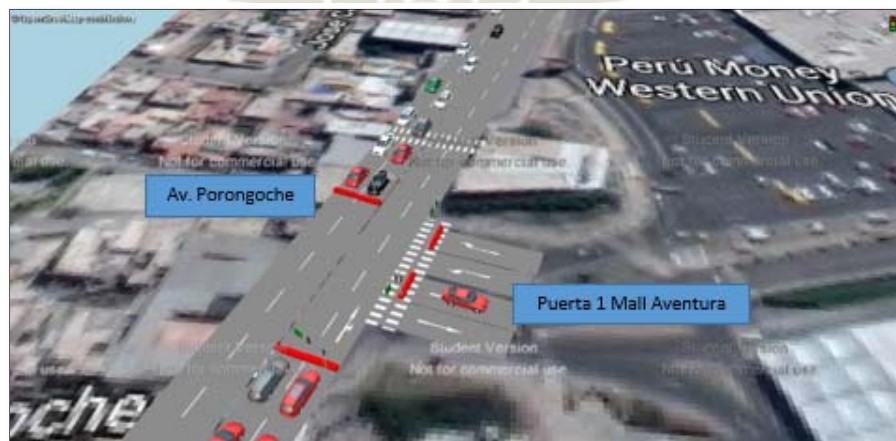
Figura 40. Simulación de estado actual en intersección ingreso y salida del Mall Aventura Plaza (Puerta N°2) - Av. Porongoche Fuente: Elaboración propia con base en PTV Vissim 9.
