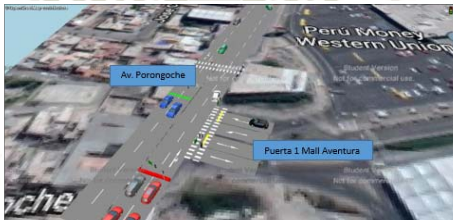
Figura 39. Simulación de estado actual en intersección ingreso y salida del Mall Aventura Plaza (Puerta N°2) - Av. Porongoche Fuente: Elaboración propia con base en PTV Vissim 9.
