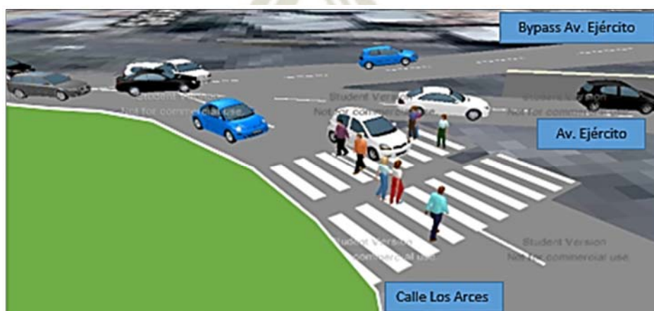
Figura 54. Simulación de estado actual en intersección Av. Ejército - Cl. Los Arces Fuente: Elaboración propia con base en PTV Vissim 9.
