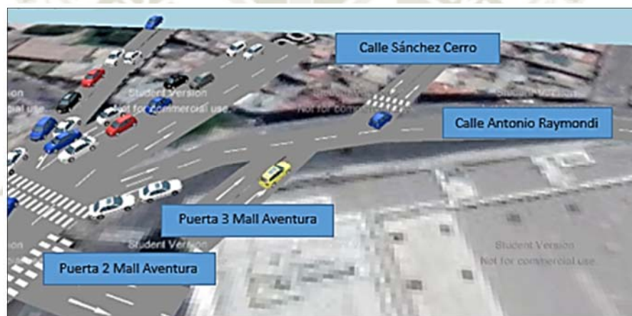
Figura 43. Simulación de estado actual en intersección salida Mall Aventura Plaza (Puerta N°3) - Cl. Antonio Raymondi Fuente: Elaboración propia con base en PTV Vissim 9.
