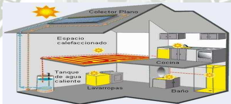
Figurara 2.2 sistema térmico de baja temperatura ( http://www.afinidadelectrica.com.ar/articulo.php?IdArticulo=33 )
