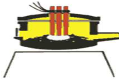
Figura 2.19 horno eléctrico de arco ( www6.uniovi.es/usr/fblanco/Leccion11.HornosARCO.ppt )
