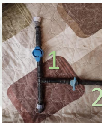
Fotografía 7: Sistema en T para la aplicación de fertilizante potásico de la investigación
