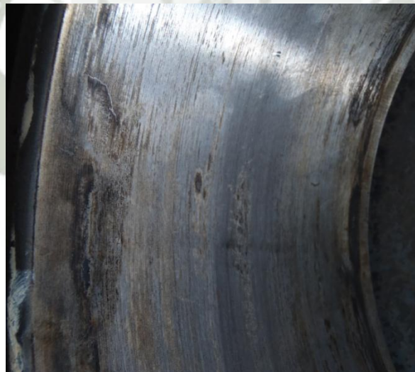
Botella porta rodamientos de rodillos cilíndricos lado acople presenta corrosión por contacto y deslizamiento circular en la superficie del agujero
