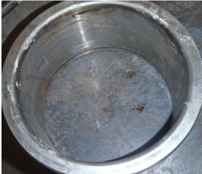
Botella porta rodamientos de rodillos cilíndricos lado acople presenta corrosión por contacto y deslizamiento circular en la superficie del agujero
