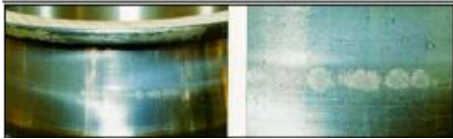
Figura 2. 18: Problema de Lubricación inadecuada
