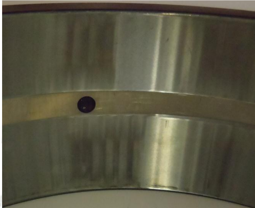
Pista exterior presenta deterioro ondulaciones en la zona de carga
