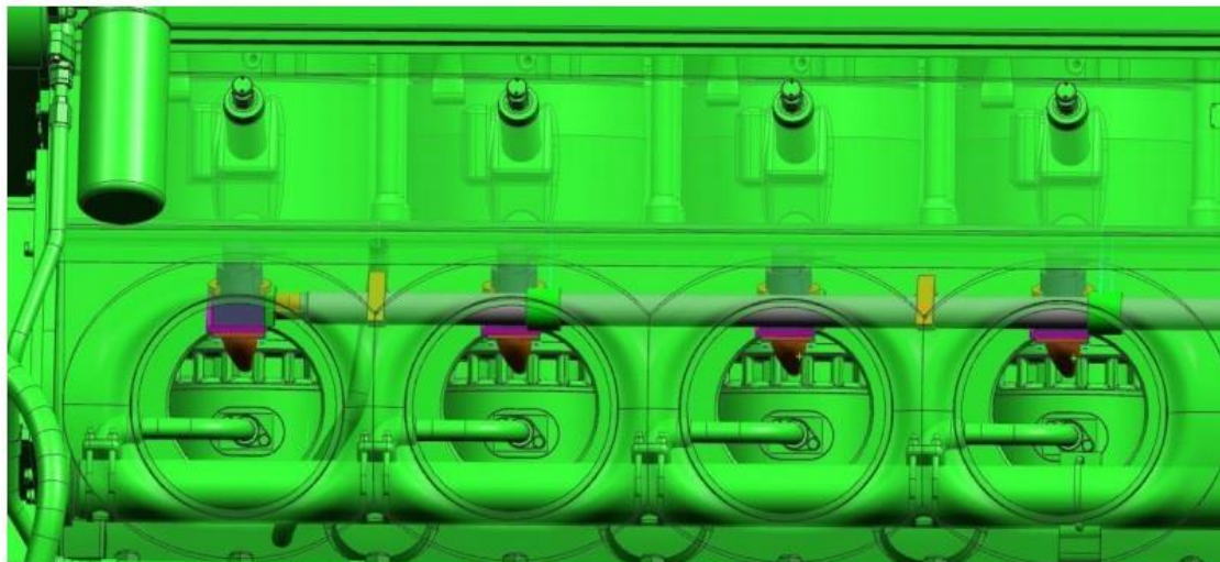
Figura 53: Introducción de gas en el sistema EMD 710 DGB
