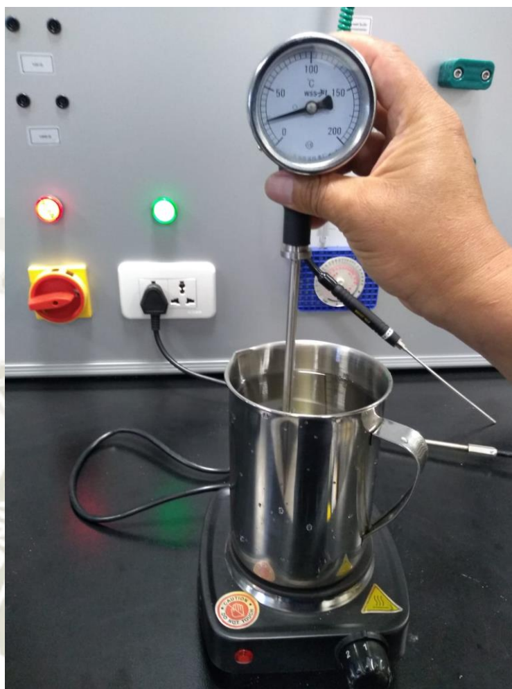
Figura 30. Prueba con Termómetro Bimetálico. Fuente: Elaboración propia.
