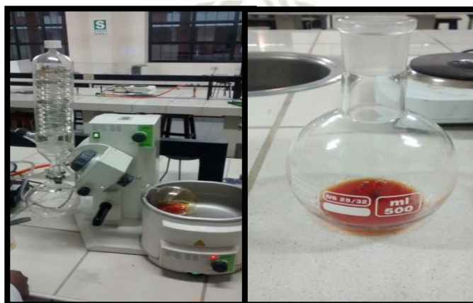
Figura N° 8. Concentración del extracto mediante rotavapor
