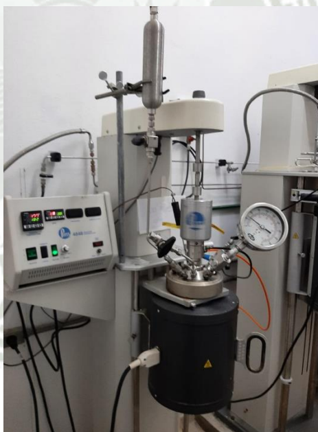
Figura 21: Reactor Parr de 2L donde se realizó el primer diseño experimental de la hidrólisis térmica o auto hidrólisis.
