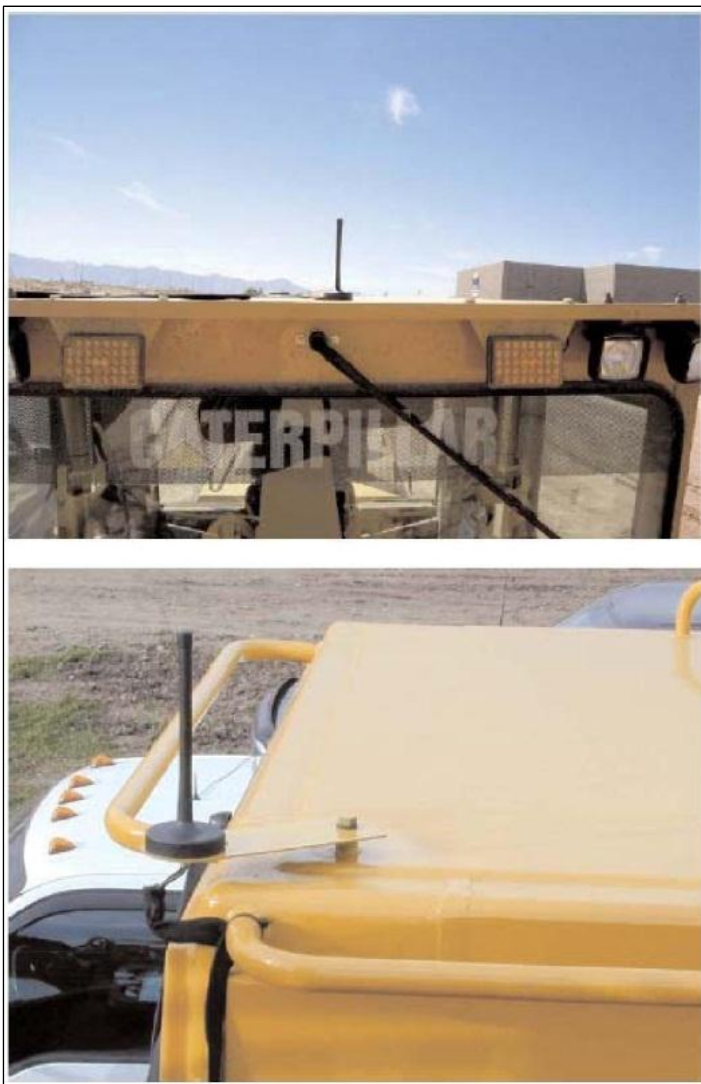
Ilustración 23. Montaje de Antena en Equipo
