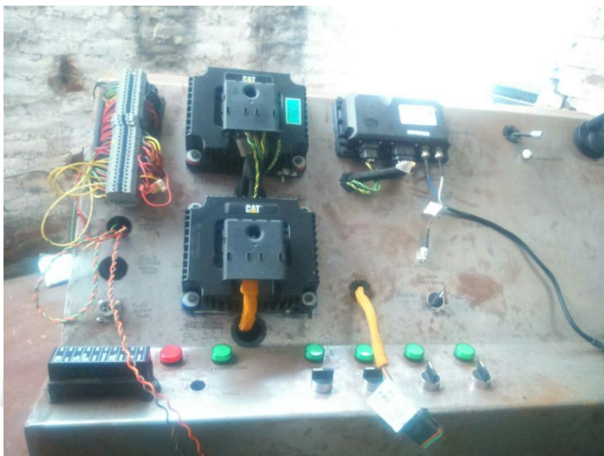
Ilustración 83. Montaje del Banco de Prueba de Product Link
