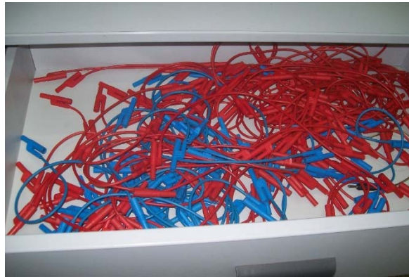
Figura 2.45: Cables con conectores de seguridad para las conexiones eléctricas.
