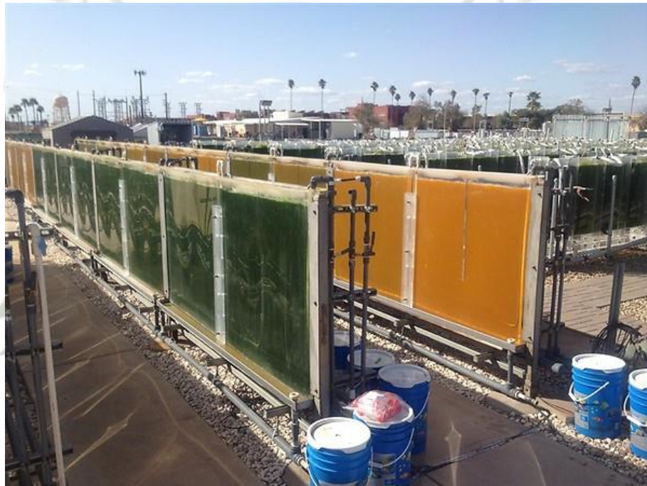
Figura 7. Fotobiorreactor tipo panel (Fuente: Ami Ben-Amotz et al., 2009)
