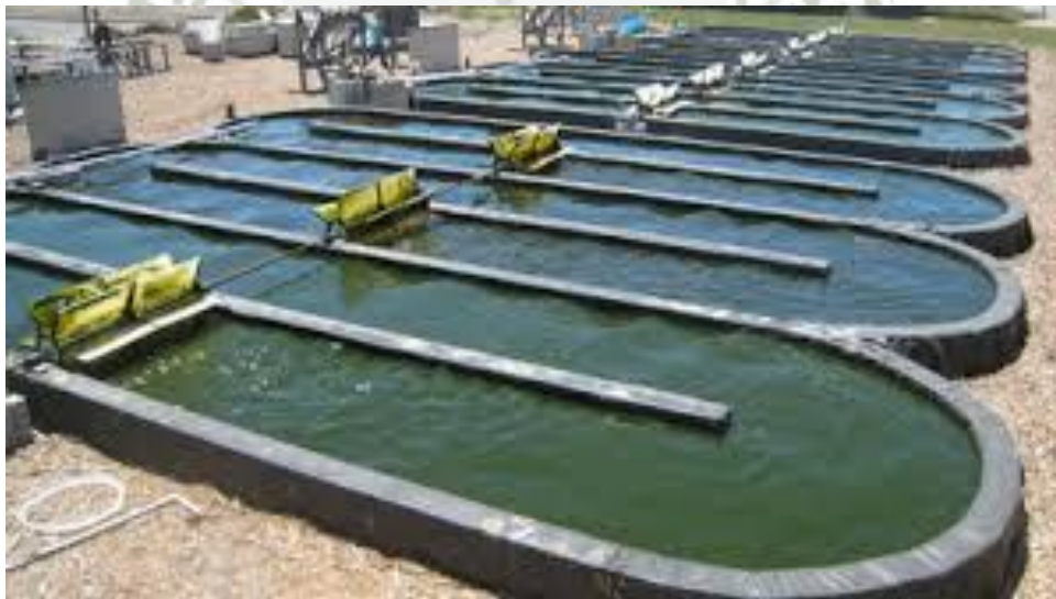
Figura 9. Sistema abierto de cultivo que muestra una estanque con rueda de paletas (Ami Ben-Amotz et al, 2009).
