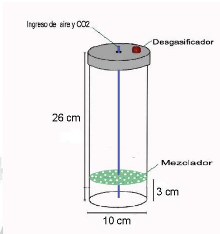
Figura 11. Esquema del fotobiorreactor tubular que muestra la adición de un mezclador (placa con poros).
