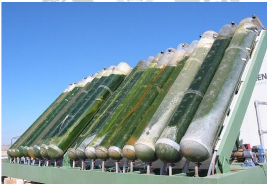
Figura 8. Fotobiorreactor tubular. (Fuente: Ami Ben-Amotz et al., 2009)
