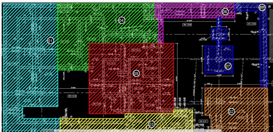
Ilustración 17: sectorización de la cimentación
