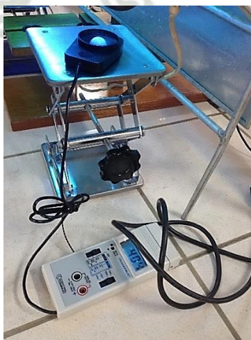
Fig. 8 Medición del nivel de iluminación por medio de un luxómetro.
