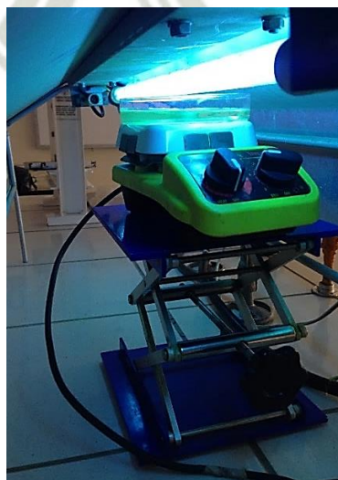
Fig. 7 Equipo para la degradación fotocatalítica UV/TiO 2 de ceftriaxona.
