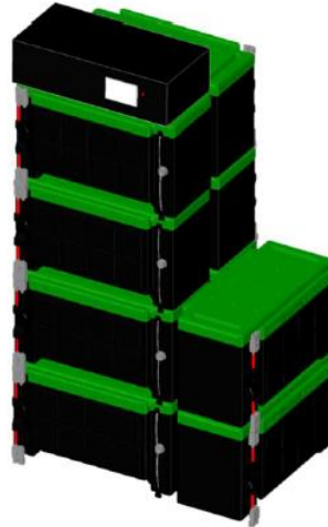
Figura 31. Imágen referencial de conexión de baterías de Litio -LFP (10unidades). Adaptación propia, 2020.
