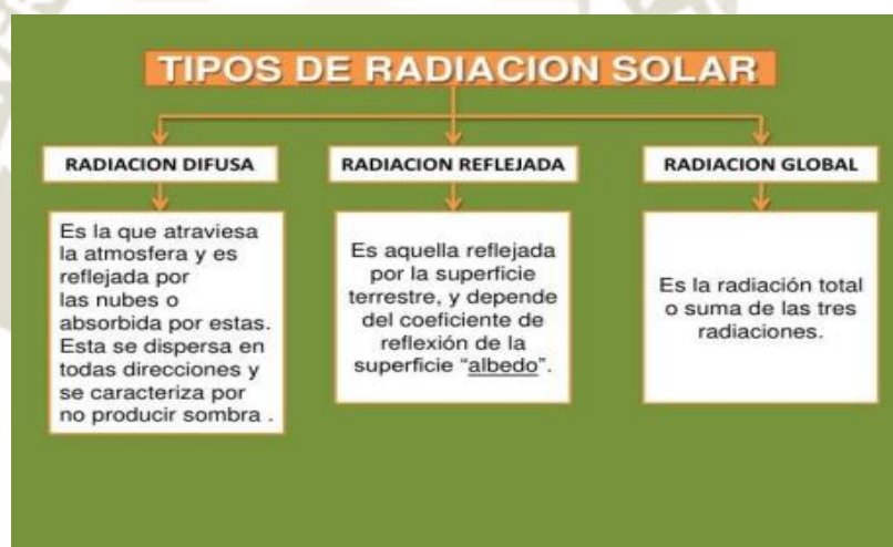
Figura 3. Los tres principales tipos de radiación Solar y el concepto de cada uno de ellos. Adaptado de "Radiación Solar" por C. Garnica , 2010.
