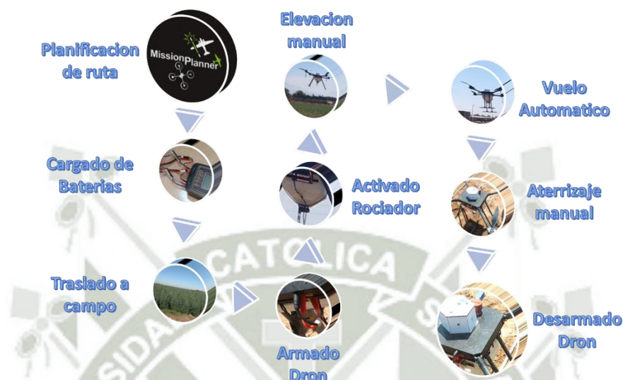
Figura 7 Procedimiento uso Dron Prototipo Fuente: Elaboración Propia
